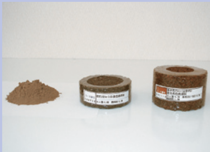
▼フィラー(アスファルトの材料)
