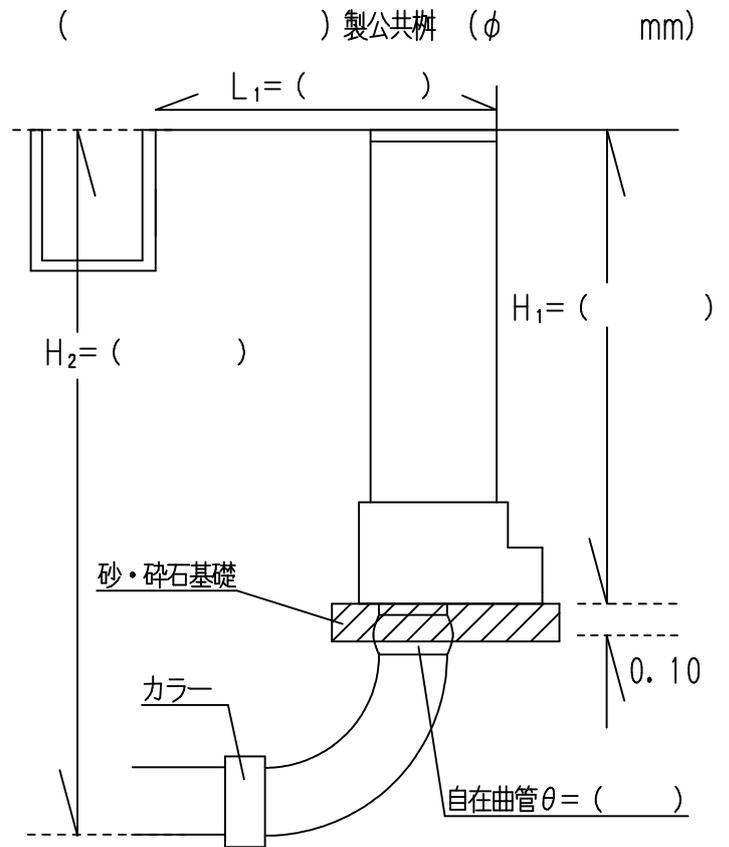
※取付管が陶管の場合は、必ず陶管用継手を使い、接続部にはモルタル充填を行うこと。
